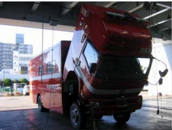
キャブ一体型ボディーながらキャブチルトによる整備性の向上を軽量FRPボディーが可能にしました。
